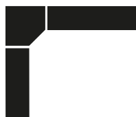
I. Hoekopstelling 2 valse verstekverbindingen
